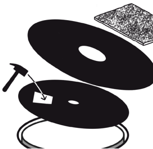
'Pompgat' uit deksel breken, deksel, spatscherm en grindmat plaatsen
