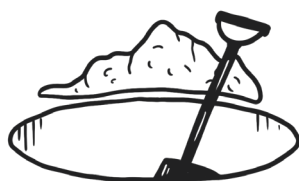
1. Reservoir ingraven ±10cm onder maaiveld
