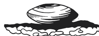
9. Afwerken met 3-5cm grind (±90liter)
