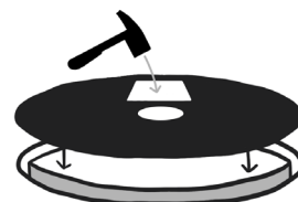
3. 'Pompgat' uit deksel breken, deksel op reservoir plaatsen
